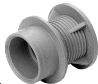
Betongrauer Konus mit Wassersperre zur Vergrößerung der Auflagefläche der Distanzrohre auf der Schalung. Verbleibt nach dem Betonieren im Beton. Lieferbar für verschiedene Durchmesser. Wasserdichter Verschluss nur mit Opti-Stopfen möglich! Prüfberichte auf Anfrage.
