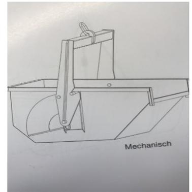
Mit ab klappbaren Bügel, Einhänger und Verschlussriegel zur selbständigen Entleerung der Mulde ohne zweiten Mann. Durch klappbaren Aufzughügel besonders geeignet zu Befüllen mit kleineren Baumaschinen. Stapelbar durch konische Muldenform.
