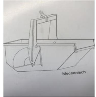
Mit ab klappbaren Bügel, Einhängerung und Verschlussriegel zur selbständigen Entleerung der Mulde ohne zweiten Mann. Durch klappbaren Aufzugbügel besonders geeignet zu Befüllen mit kleineren Baumaschinen. Stapelbar durch konische Muldenform.
