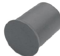
für das dichte Verschließen von OKTAGON® Konus. Nur einschlagen, nicht kleben! Durch den langen Stopfen einfache und schnelle Arbeitsweise. Die massive Ausführung des Stopfens erhöht die Sicherheit des Systems. Einbautiefe ca. 12 mm
