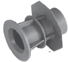
Vorsatzkonus OKTAGON® Konus für die Selbstherstellung von wasserdichten Schalungsspannstellen. Durch Ablängen eines Kunststoffrohres 22/26mm um 8cm kürzer als die gewünschte Wandstärke und Aufpressen eines OKTAGON® Konus, können Sonderlängen mit den Eigenschaften von OKTAGON® hergestellt werden.
